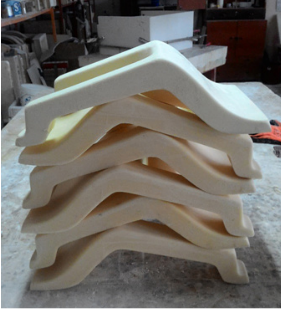
Fotoğraf 10. Seri üretimde kullanılan poliüretan destekler (Fotoğraf: Mustafa Ural, 2016).
