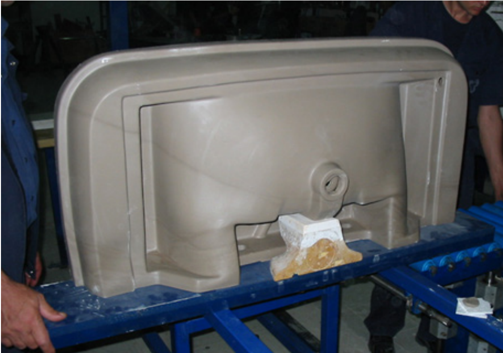
Fotoğraf 1. Kalıptan Yarı Ürün Alma Ceketı (Fotoğraf: Mustafa Ural, 2005).
