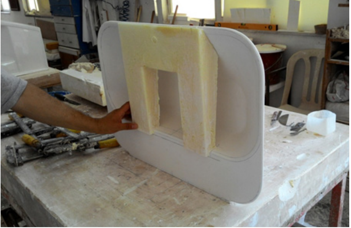
Fotoğraf 3. Model üzerinden poliüretan desteğin ayarlanması (Fotoğraf: Mustafa Ural, 2015).
