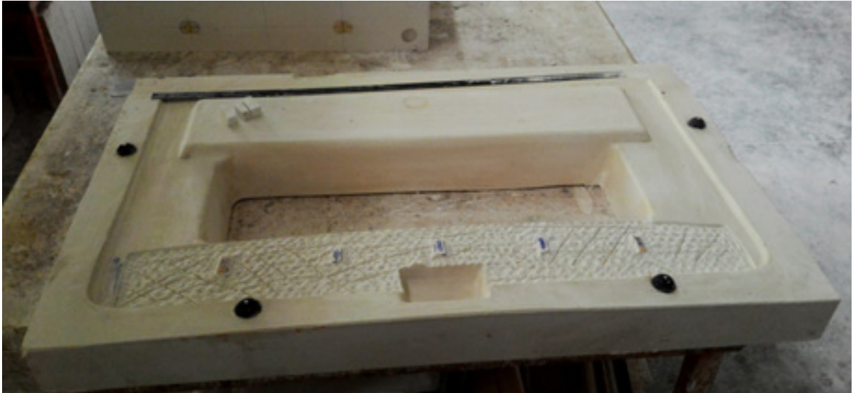
Fotoğraf 2. Tadilat çalışması yapılan yatırma ceketi (Fotoğraf: Mustafa Ural, 2014).
