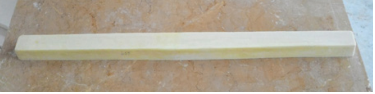
Fotoğraf 6. Poliüretan malzemeden yapılmış düzeltme mastarı (Fotoğraf: Mustafa Ural, 2016).
