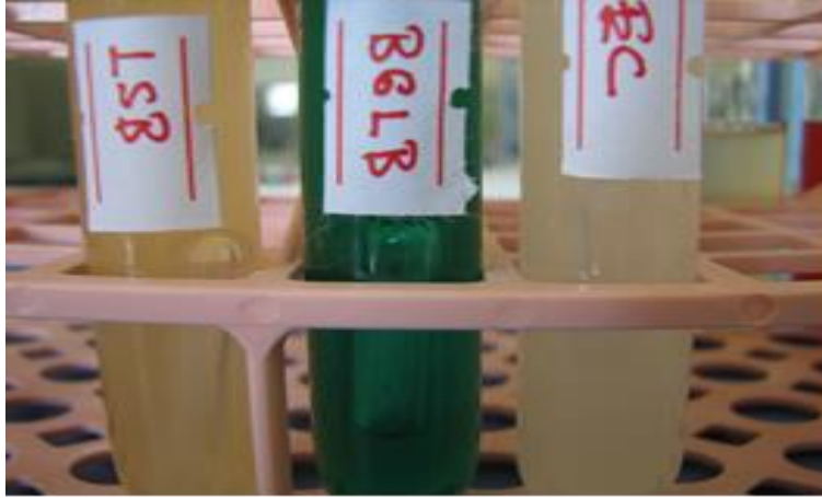
Şekil 2. En Muhtemel Sayı Yöntemiyle koliform grubu bakterilerin varlığını gösteren pozitif tüplerden örnek görüntü.
