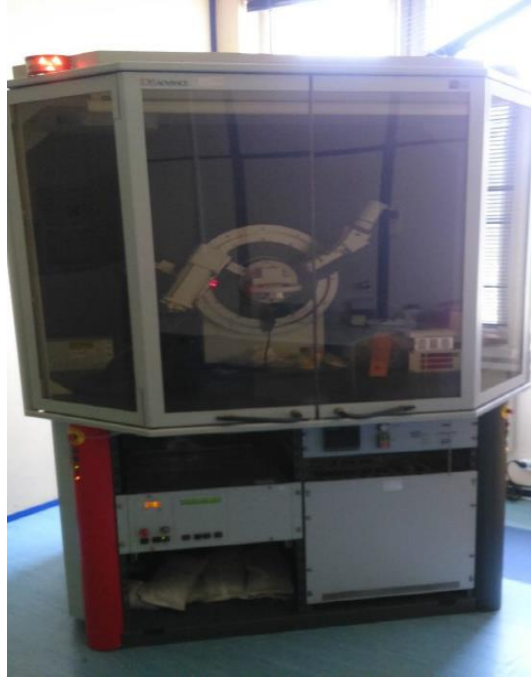
Şekil 2. Numunelerin kırınım deseninin alındığı Bruker AxsDS Advence model difraktometre
