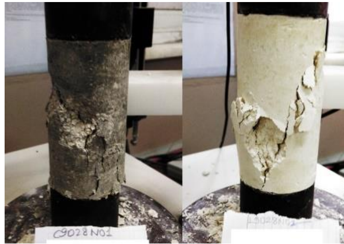
Şekil 5. %9 katkı içeren örneklerde gelişen kırılma yüzeyleri (Soldan sağa sırası ile C9 ve L9 örnekleri).
