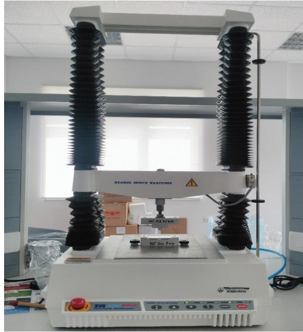
Şekil 2. Bükme deney düzeneğinin genel görüntüsü
