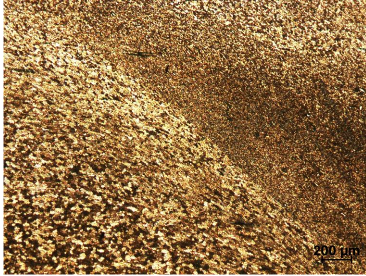
Şekil 6. Vidalı karıştırıcı uçla birleştirilen numuneye ait optik mikroskop görüntüsü.
