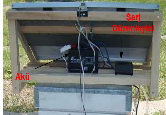
Şekil 7. Güneş paneli, akü ve şarj düzenleyici.
