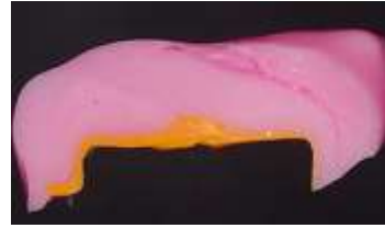
Resim 14. İncele örneklerinin kenar ve iç yüzey uyumunu gösteren silikon replika kesiti.
