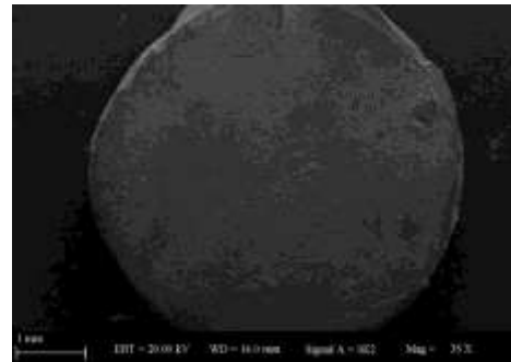
Şekil 3. Tip 1 kopma paterni görülen seramik yüzeyi SEM görüntüsü (x35)
