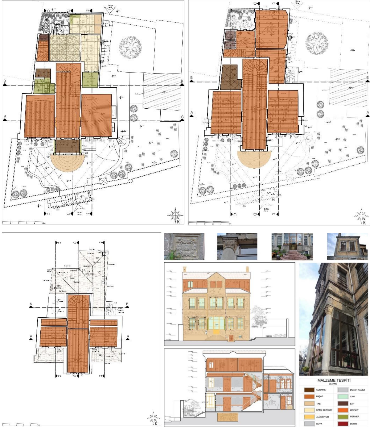
Şekil 14. Yapıda birçok farklı malzeme kullanılmıştır
