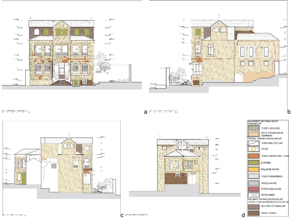
Şekil 15. Yapının cephelerine ait bozulma analizi
