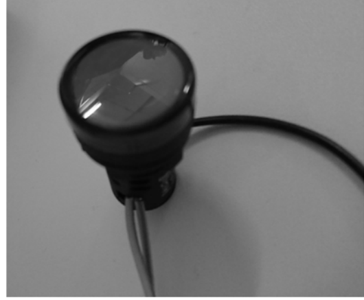
Şekil 4. Sensörün çıktısını belirlenmesinde kullanılan led ampul
