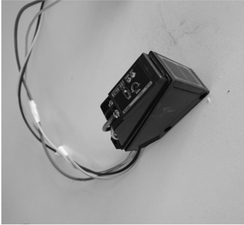
Şekil 3. Denemelerde kullanılan foto elektrik sensör
