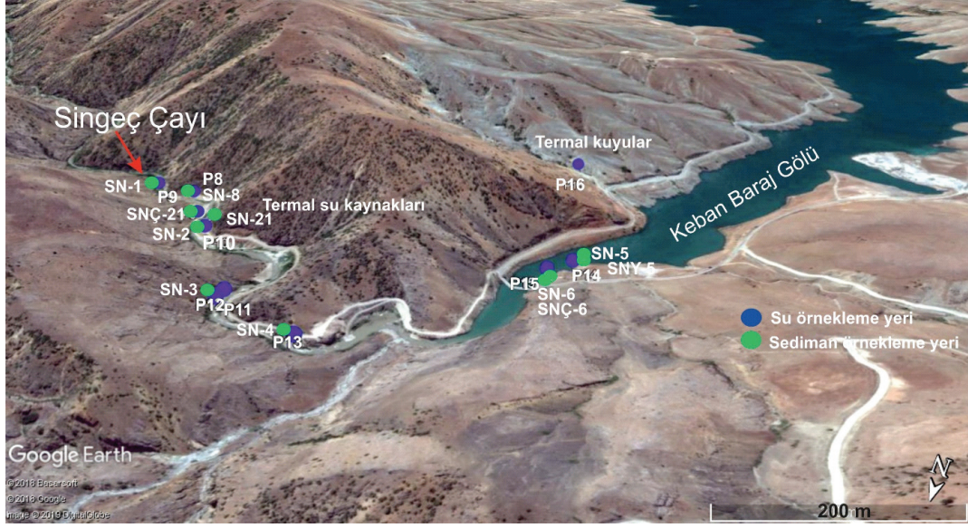
Şekil 2. Singeç Çayı'nın faya paralel olarak KB-GD akışa sahip olduğu yerde ortaya çıkan yeraltı suları ve örnekleme noktalarının yeri (taban görüntü, Google Earth'den alınmıştır).
