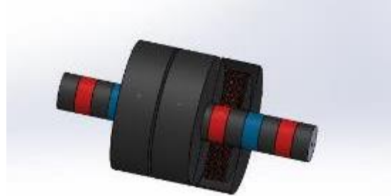
Şekil 4.14 Yukarıdaki ölçülere göre tüp şeklinde LM' nin SW' da çizilmesi.
