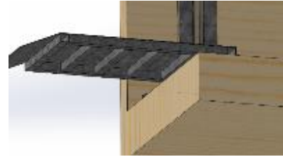
Şekil 4.18 Kaldırma platformu destek profilleri SW çizimi.
