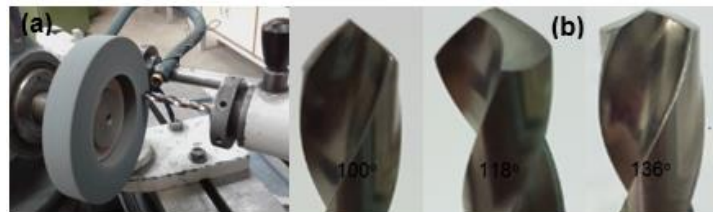
Şekil 2. a) Takım bileme makinesi, b) değişik uç açılı matkap uçları.
