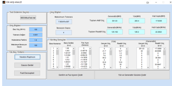
Şekil 16. Yük akış analizi programında Newton-Raphson yönteminin çalıştırılması
