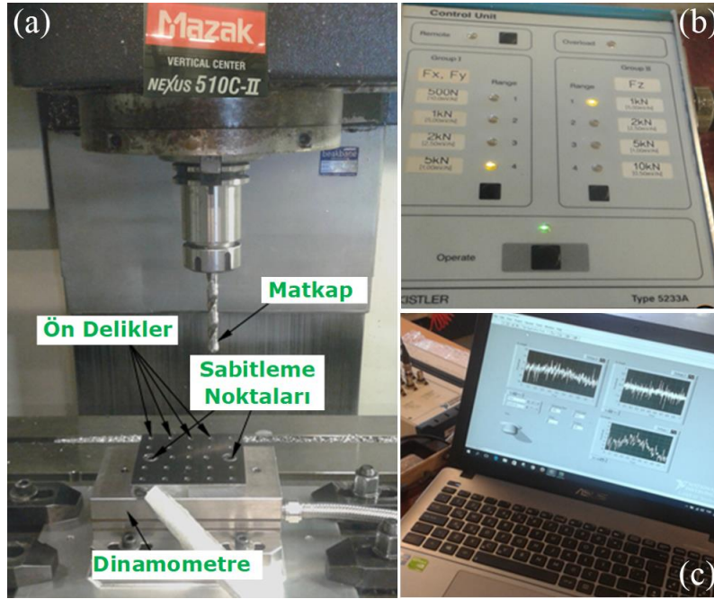
Şekil 1. Deney düzeneği, a) CNC freze tezgâhı, b) 5233 A tip dinamometre, c) bilgisayar.
