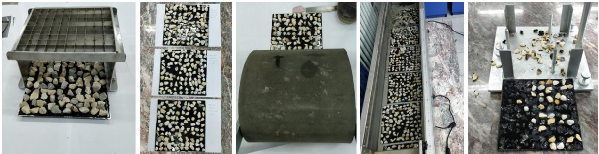
Şekil 8. Vialit yapışma deneyi görüntüleri.
