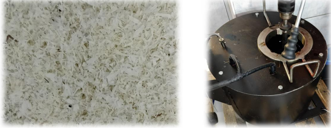
Şekil 4. Atık PVC katkı ve bitüm katkı karışım cihazı (modifikatör).
