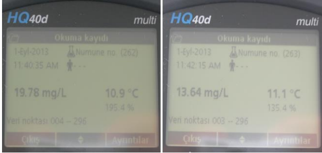
Şekil 1. Oksijen metre (Hach Lange HQ40d multimetre) ile havuz girişinde kaynak suyunun ölçüm sonuçları.
