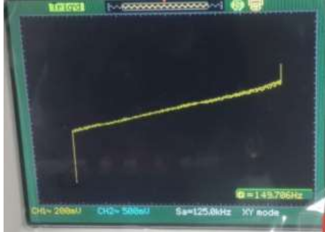
Şekil 10. 150 Hz sinüsoidal gerilimle beslenen memristör taklitçisinin histerezis eğrisi
