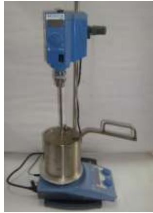
Şekil 2. Modifiye bitüm hazırlama mikseri
