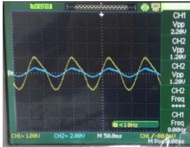
Şekil 6. 8 Hz Sinüsoidal gerilimle beslenen memristör taklitçisinin akım ve gerilim grafiği (CH1: Gerilim, CH2: Akım)
