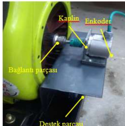
Şekil 5. Enkoderin motor üzerine montajı
