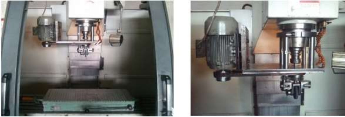
Şekil 1. GMASRA'nın CNC dik işleme merkezine montajı
