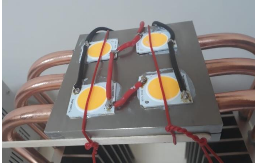
Şekil 3. LED'lerin Elektriksel Bağlantısı ( Electrical Connection of LEDs)
