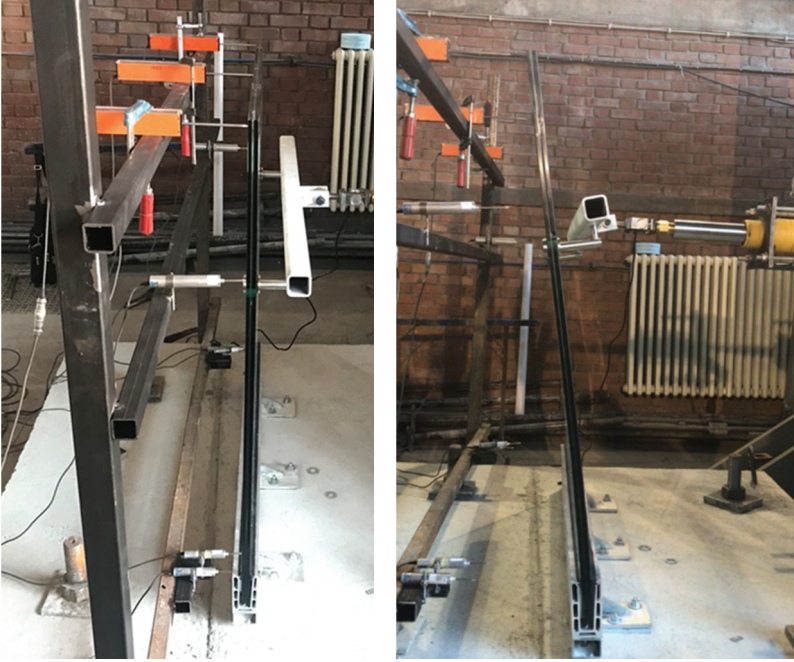
Şekil 5 - Yük altında elastik korkuluk deformasyonu
