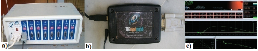
Şekil 6 - Ölçüm Cihazları a) veri toplama ünitesi, b) aygıt geçidi, c) CoDA Locomotive programına yüzü
