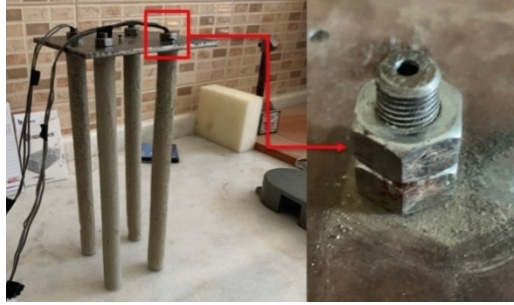
Şekil 4 - Model kazıklı radye temel ve rijit birleşim detayı
