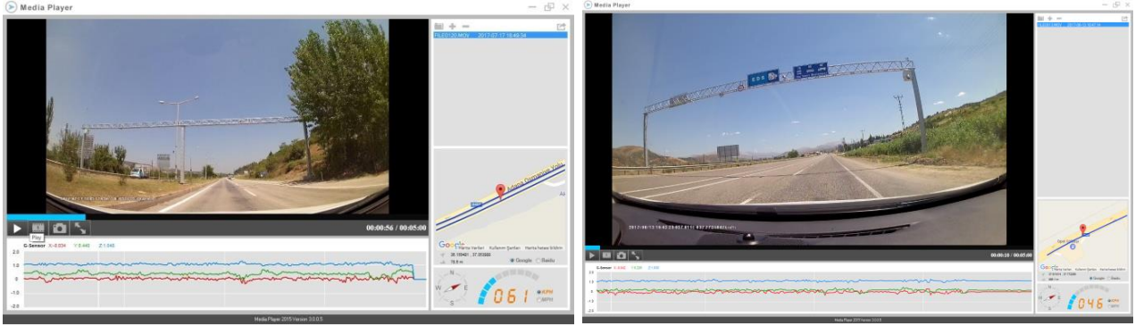
Şekil 10. GPS özelliği olan araç içi kamera ile elde edilen konum, süre ve hız verilerinin bilgisayar ortamında incelenmesi.
