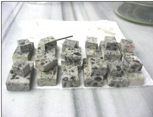
Şekil 2. TEM numunelerinin hazırlanması
