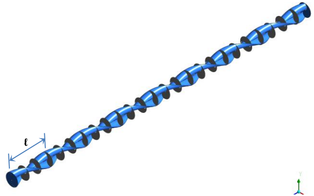
Şekil 2. Ters kavisli kesite sahip bükümlü bant üzerindeki verilerin alındığı kesitler
