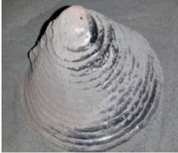
Şekil 3. Swamp Works 3D Regolith Construction işlemi tarafından oluşturulan küçük çaplı yapılar [Mueller, 2017]
