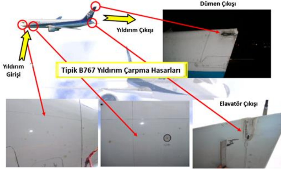
Şekil 7. Metalik uçak kabuğu üzerinde süpürülme kanalı kaynaklı yıldırım çarpması hasarları [9]
