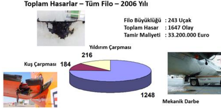
Şekil 3. Lufthansa filosunun kompozit parçalarının tecrübe ettiği hasarlar [8]
