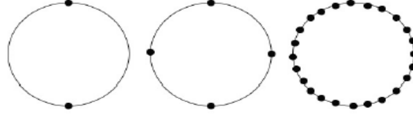
Şekil 5. İki, Dört Ve Yirmi dört Sensörlü Robotun Şematik Gösterimi
