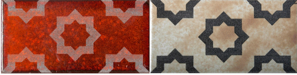
Resim 9. Yüzeye lazerle kazınmış desenler. 10 x 20 cm’lik bordürlerde başlık hızı ve güce (s 20 / p 100) göre yapılan uygulama 18’er dakika sürmüştür. (Tasarım ve uygulama: Efe Türkel, Tolga Benli, 2019).
