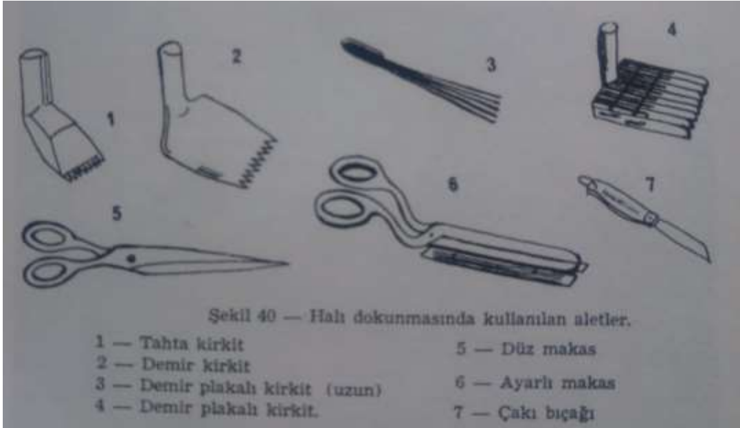
Görsel 7. Halı dokumasında kullanılan aletler (Aytaç, 1982:129).
