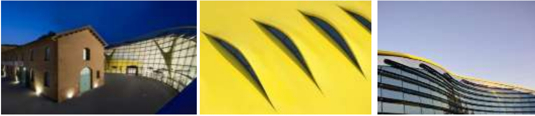
Görsel 13. Geniş cam yüzeyli giriş cephesinin mevcut yapıyı vurgular şekilde içe kavisli tasarımı ve çatı örtüsündeki kavisli yarıklar ve giriş cephesinde cam malzeme kullanımı.
