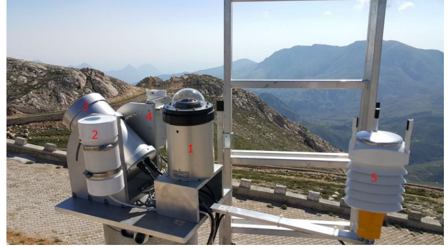
Şekil 1. GÖKSİS sisteminin temel ölçerleri; 1-ASC: Tüm Gökyüzü Kamerası, 2- SQM, 3-SM, 4-BW: Bulutluluk Ölçeri ve 5-Meteoroloji İstasyonu.
