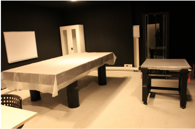
Şekil 3. DAG-ODA/IÜ laboratuvarının şimdiki hali. Biri büyük biri küçük iki adet Newport optik masa görülmektedir.
