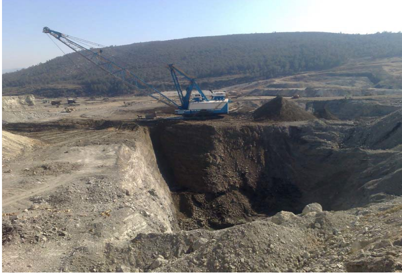
Şekil 2. Araştırmada kullanılan çekme kepçeli yerkazar görüntüsü.
