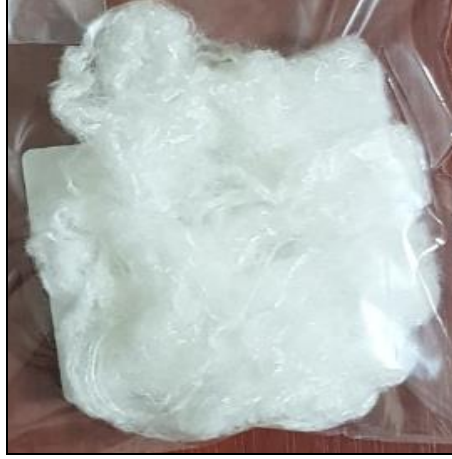
Şekil 3. Kızılcım Odunundan Elde Edilen Viskoz Rayon Lifleri
