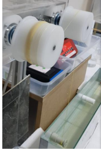
Şekil 2c. Viskoz Rayon Liflerinin Godetlere Sarımı
