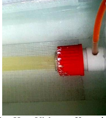
Şekil 2b. Düzedeki Deliklerden Ham Viskozun Koagülasyon Banyosu İçerisine Sevki (Düze Delik Çapı: 0.1mm*91 adet)
