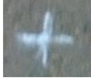
Şekil 5. Kireç ile Boyanmış Yer Kontrol Noktası (20cm çapında orta daireye sahip)
