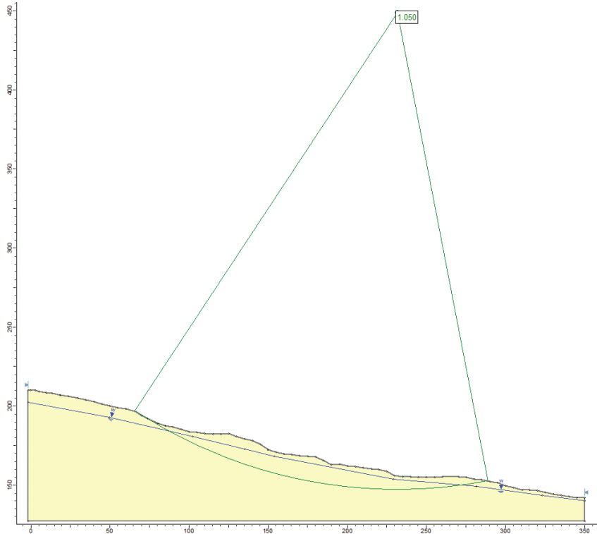
Şekil 4. 1-1' kesit hattındaki heyelanın statik şartlarda kayma daresi ve güvenlik sayısı.
