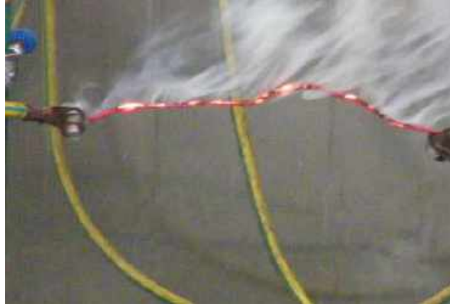
Resim 1. Aşırı akım çekilen kablo yangını
