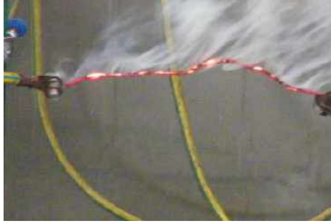
Resim 1. Aşırı akım çekilen kablo yangını
