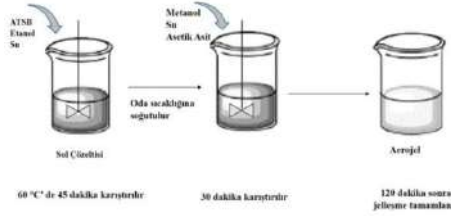
Şekil. Alümina alkojel sentezinin şematik gösterimi / Figure. Schematic representation of alumina alcolgel synthesis
