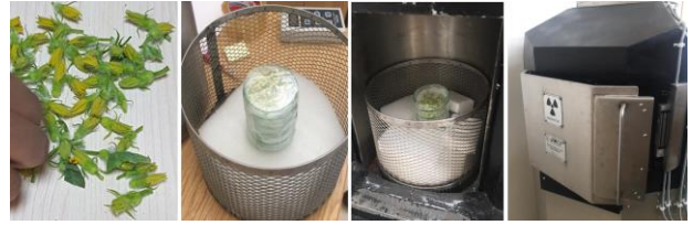
Şekil 3. Anthesisten bir gün önce toplanan erkek hıyar çiçekleri, petri kutularında ışınlama işlemi ve ışın kaynağı
