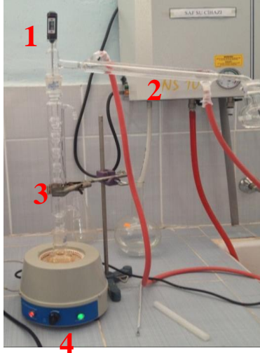
Şekil 1. Vigreux Kolonlu Ayrımsal Damıtma Test Düzenegi.
