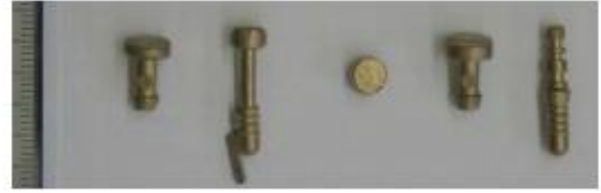
Şekil 2. Mikro Toz Enjeksiyon Döküm ile Üretilen Mikro Vidalar [5]
