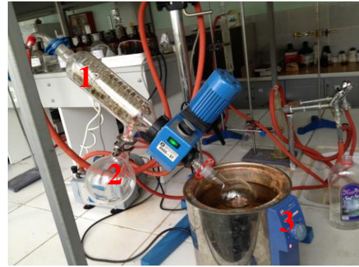
Şekil 2. Döner Başlıklı Dik Ayrımsal Damıtma Düzenegi.
