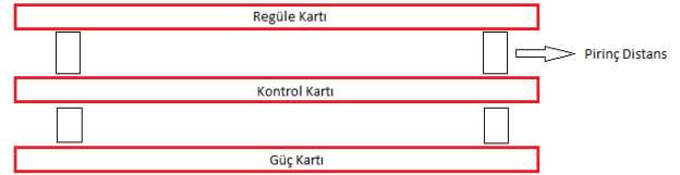
Şekil 1. Motor Sürücü Sistemine ait kartların sistem içerisinde yerleşimi ön görünümü
