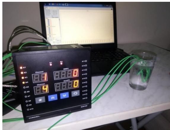
Şekil 6. Deney düzeneği sıcaklık ölçme sistemi kalibrasyonu
