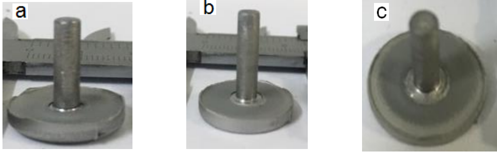
Şekil 9. 1200 °C de 240 dakika sinterlenen numuneler a) 1.0535 (AISI 1050) b) 1.7225 (AISI 4140) c) 1.0402 (AISI 1020) çeliği
