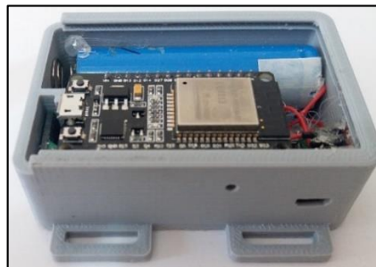
Şekil 5. Geliştirilen kablosuz takip cihazı (Developed wireless tracking device)
