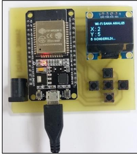
Şekil 3. Geliştirilen saha analiz cihazı (Developed field analyzer)
