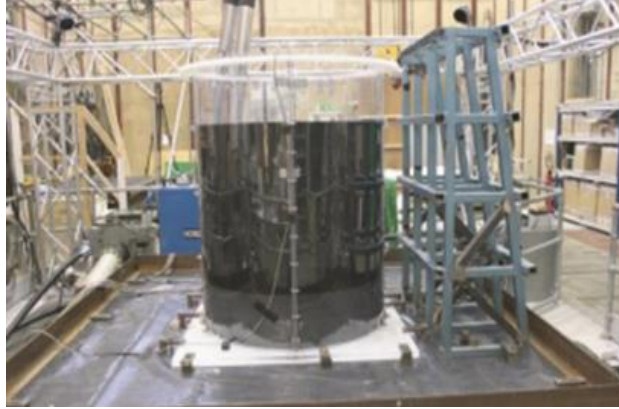
Şekil 17. Silvestri ve vd. Sarsma tablası testi (Silvestri et al. Shaking table test)
