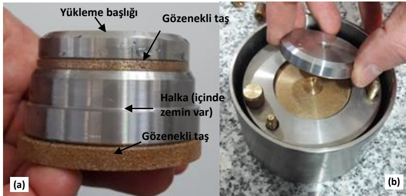
Şekil 1. Konsolidasyon deneyinde, a) gözenekli taşların yerleştirilmesi, b) numunenin konsolidasyon hücresine yerleştirilmesi (In the consolidation test, a) placing porous stones, b) placing the sample in the consolidation cell)
