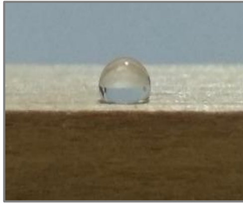
Şekil 3. 5 µl'lik su damlası görüntüsü (5 µl water drop view)
