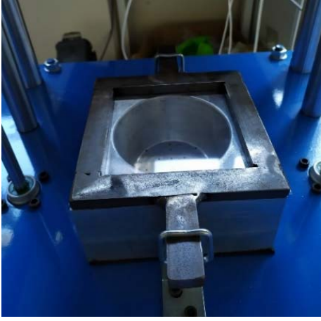
Şekil 2. Tutucu, PVC film ve konik dişi kalıp
