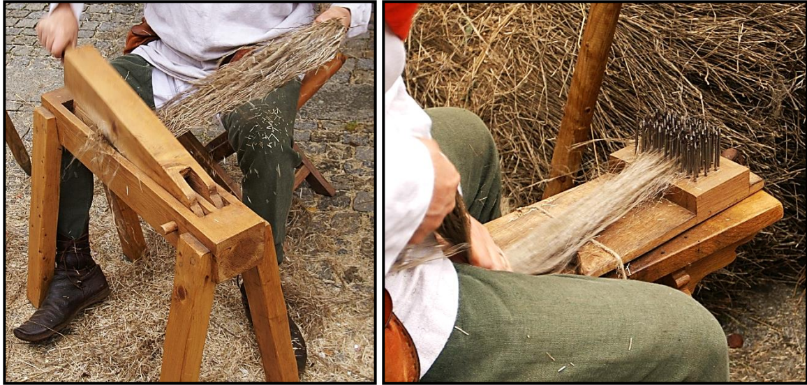
Fotoğraf 2. Liflerin Mengenezden Geçirilmesi (Solda) ve Taranma Aşamalarından Görünümler 2
