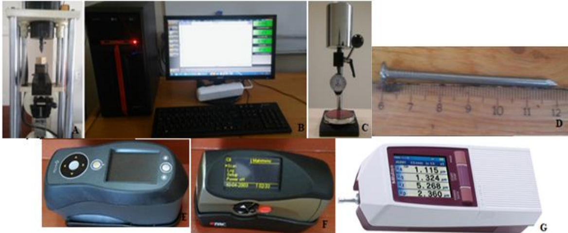
Şekil 1. Janka statik sertlik deneyini yapılışı (A-B), Shore-D sertlik cihazı (C), çalışmada kullanılan çivi (D), renk ölçüm cihazı (E), parlaklık cihazı (F), yüzey pürüzlülüğü cihazı (G)
