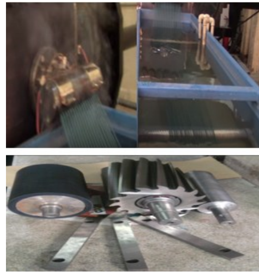
a) Süzgeç b) Soğutma Havuzu c) Kesme Bıçakları
