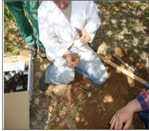
Şekil 14. Deneme alanından bozulmamış toprak örneği alma işlemi
