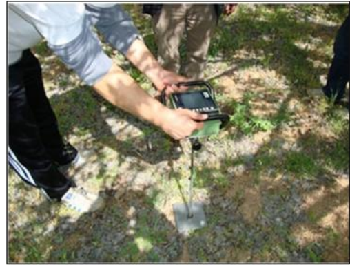
Şekil 12. Penetrasyon direnci ölçme işlemi
