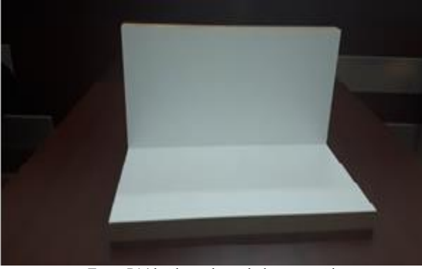
Tenso P14 bağlantı elemanı deney örneği
