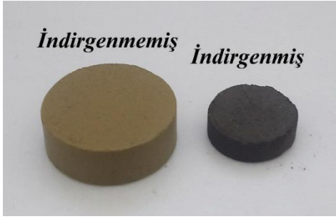
Şekil 3- Ham ve indirgenmiş MHP+kömür peleti.
