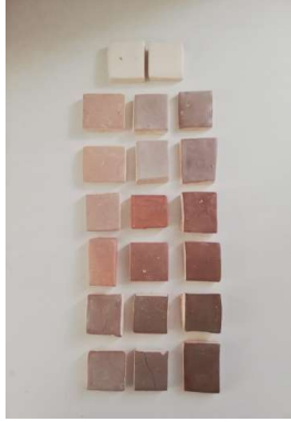
Şekil 1. Ham halde bulunan, 1000 ve 1100°C'de kalsine edilmiş olan fan tozunun görüntüleri
