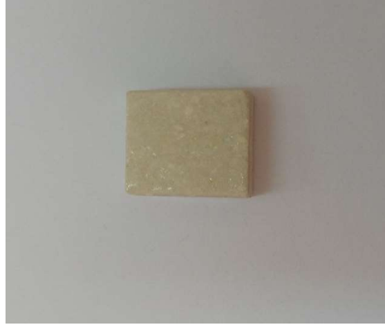
Şekil 6. Üretilen %0,5 Katkılı Kalsiyum Boratlı Sırlı Seramik Altlık Üzerine Uygulanıp Pişirilmiş Görüntüsü
