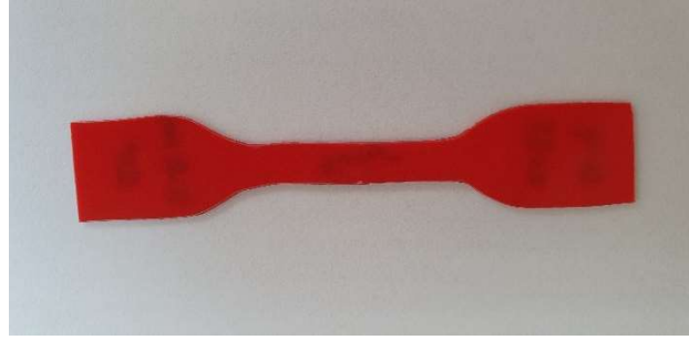
Şekil 2. Üretilen ISO 527-2 5A tipi çekme numuneleri
