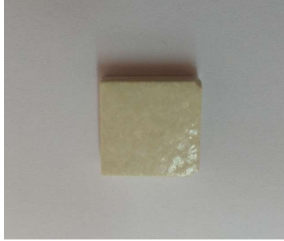
Şekil 5. Üretilen Katkısız Kalsiyum Boratlı Sırın Seramik Altlık Üzerine Uygulanıp Pişirilmiş Görüntüsü
