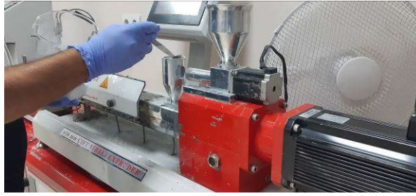
Şekil 1. Hazırlanan karışımın birinci besleme noktasından el ile beslenmesi
