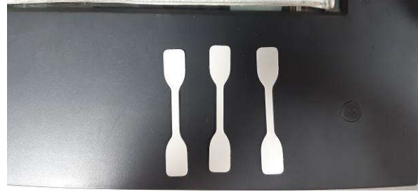
Şekil 4. Mekanik testler için basılmış kaşıkçık (Dog-bone) numuneleri
