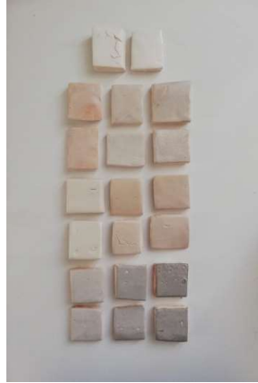
Şekil 3. 1100°C'de sinterlenen opak sırlı numunelerin görüntüleri
