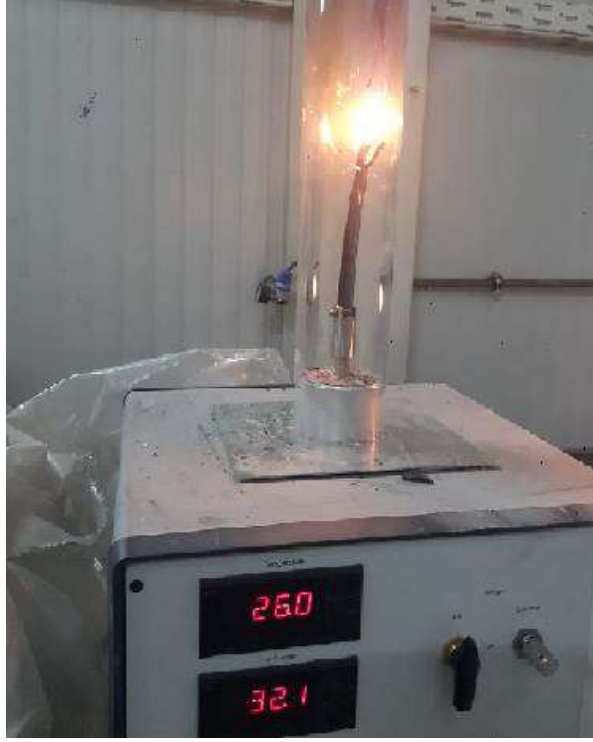
Şekil 5. LOI testi sırasında yanan bir numune
