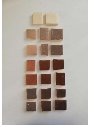
Şekil 5. 1100°C'de sinterlenen transparant sırlı numunelerin görüntüleri
