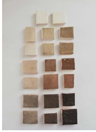
Şekil 4. 1000°C'de sinterlenen transparant sırlı numunelerin görüntüleri
