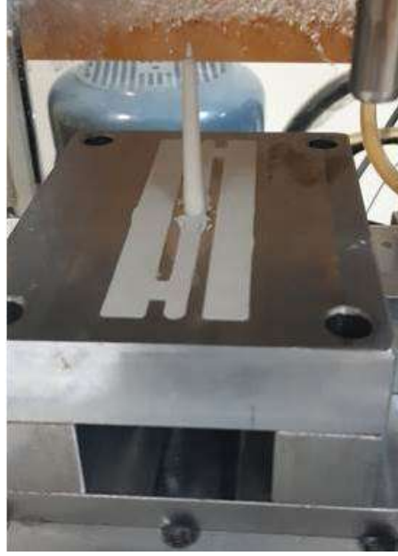
Şekil 3. Enjeksiyon makinesi LOI testi için numune basımı
