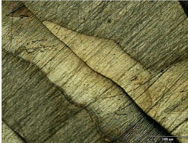
Şekil 7. Ni-B alaşım kaplamanın kırık ve çatlaklardan oluşan yüzey morfolojisi
