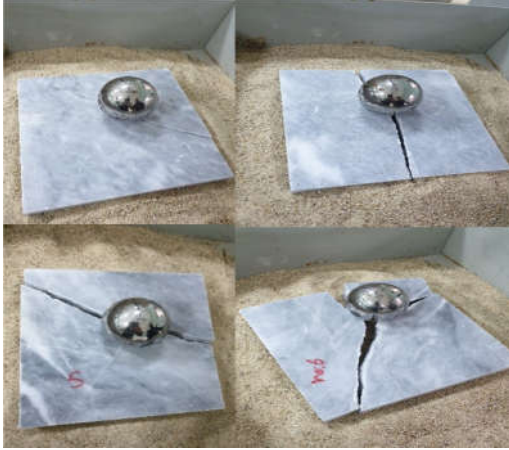
Şekil 2. Çarpma etkisi ile kopma enerjisi deneyinde örnek kırılma şekli
