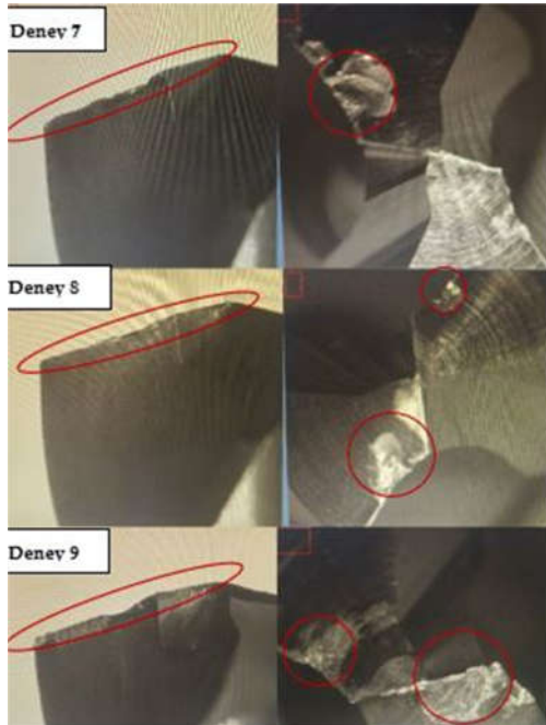
Şekil 5. Çapı 9,6 mm olan takımın deney sonrası görüntüleri
