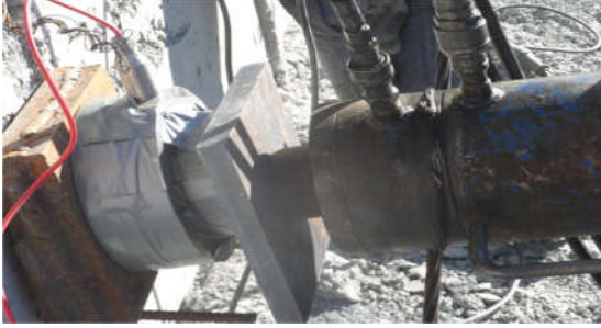
Şekil 8. Kriko kullanarak yük hücrelerinin ankraj uçlarına belirli yükler altında sabitlenmesi
