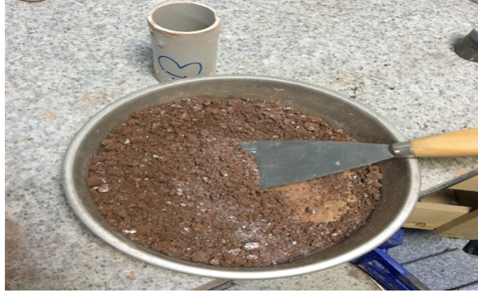
Şekil 2. Kek malzeme ile ajanın karıştırılması
