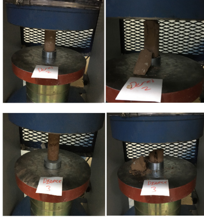
Şekil 12. 1. gün sonunda %2 ve %3 lük derrick elek ürünü kek malzeme
