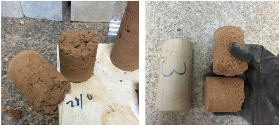
Şekil 7. Kalıptan çıkartma işlemi esnasında zarar görmüş numuneler
