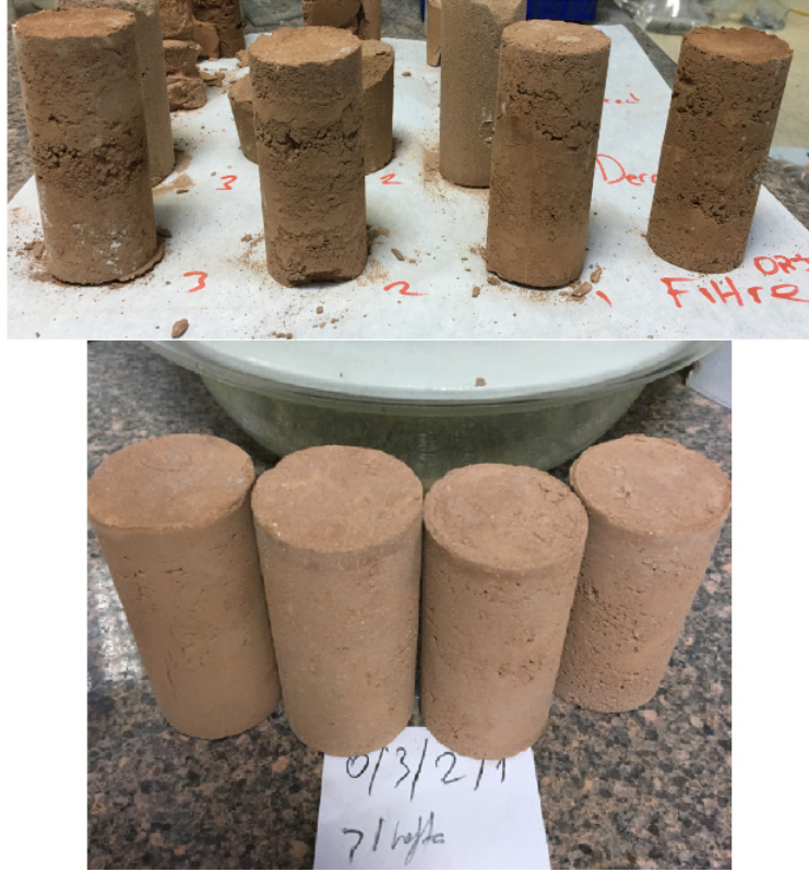
Şekil 10. 7 gün bekletilen ve Tek Eksenli Basınç Deneyi için yeterince sağlam olan numuneler
