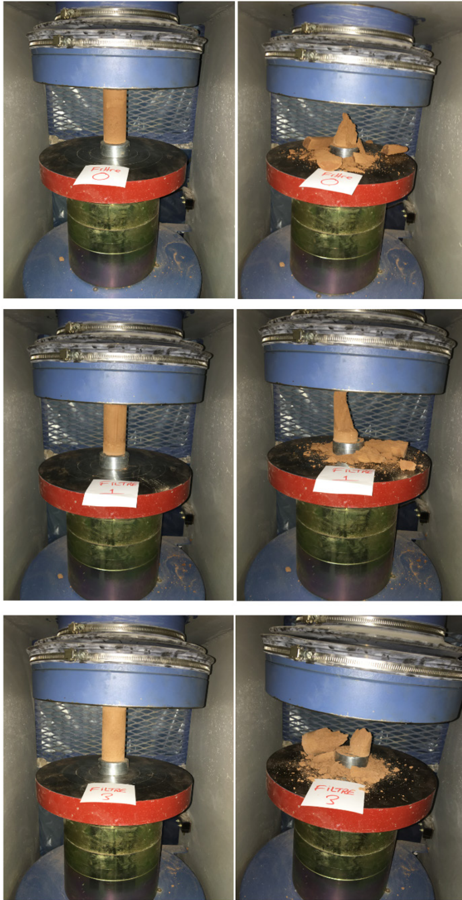
Şekil 14. 1 günlük Filtre keki numuneleri, derişimler sırasıyla %0, %1 ve %3
