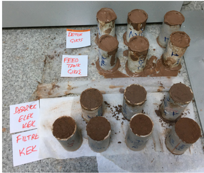
Şekil 4. PVC borudan kalıplarda bekletilen numuneler
