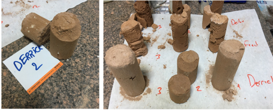
Şekil 6. Deney için uygun olmayan numuneler
