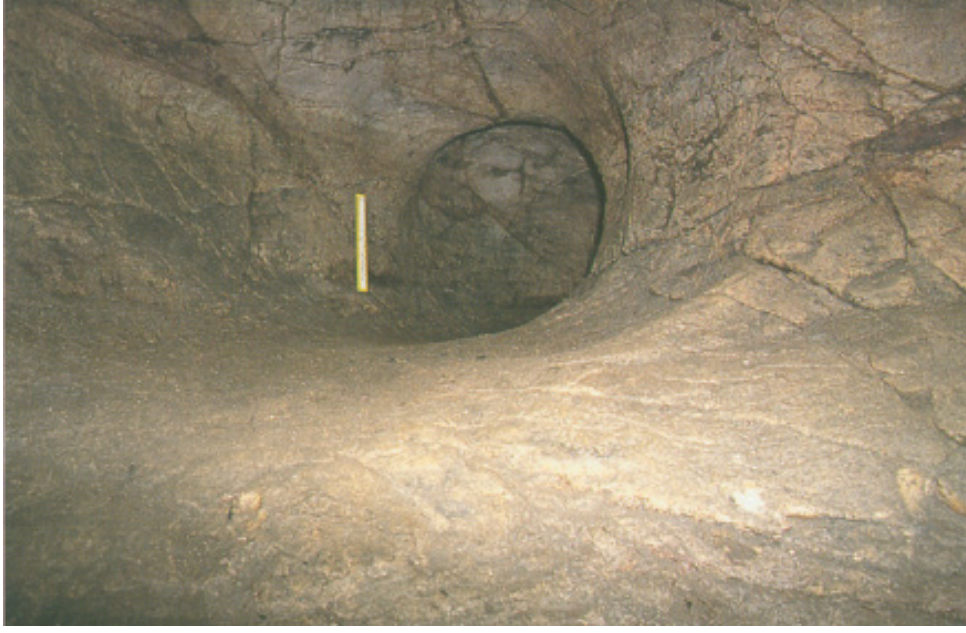
Şekil 5. Kestel madeninde ateş kurma ile sürülen bir açıklık (Craddock, 1992).
