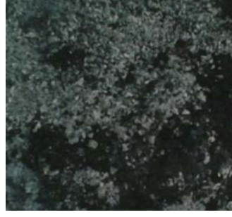
Şekil 2. Kalsine edilmiş patates kabuğu atığı külü Kaynak: Nihal Turan fotoğraf arşivi, 2019
