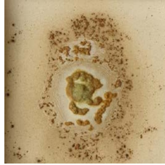
Şekil 3. Kalsine edilmiş patates kabuğu atığı külünün 1160° C'deki pişirim sonucu Kaynak: Nihal Turan fotoğraf arşivi, 2019
