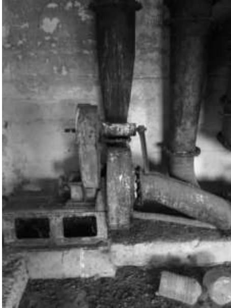
Ek 13. c. Havalandırma düzeneğini çalıştıran mekanizme. Gerektiğinde kol gücü ile de çalıştırılabilmektedir.
