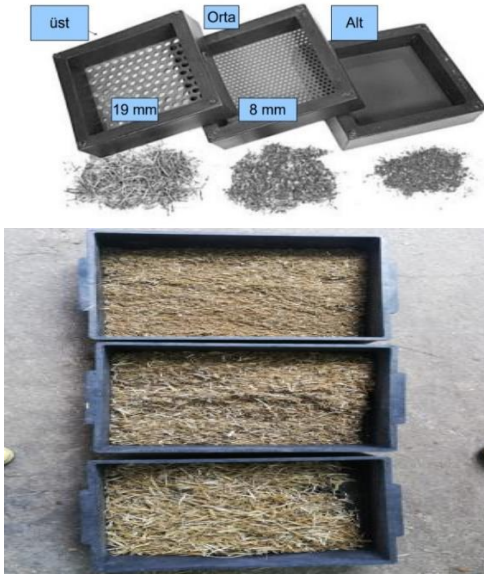
Resim 2. Penn State Partikül seperatörü Figure 2. Penn State Particle Separator
