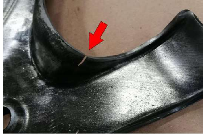
Şekil 23. S355MC malzemenin bölgesel ısıtma ve parlatma işlemi sonrası yırtılma hasarı
