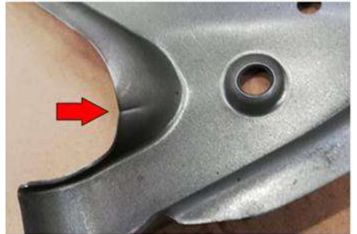
Şekil 19. S355MC Parlatma ve kalıp yağlayıcı ile gerçekleştirilen ürün
