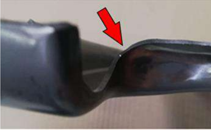
Şekil 15. DD13 Parlatma sonrası oluşan boyun verme
