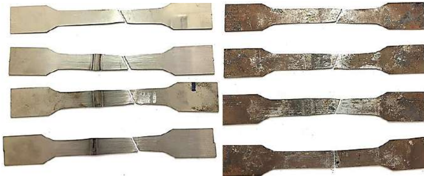
Şekil 9. A2 ve A2H numunelerinin çekme deneyi sonrası görüntüleri.
