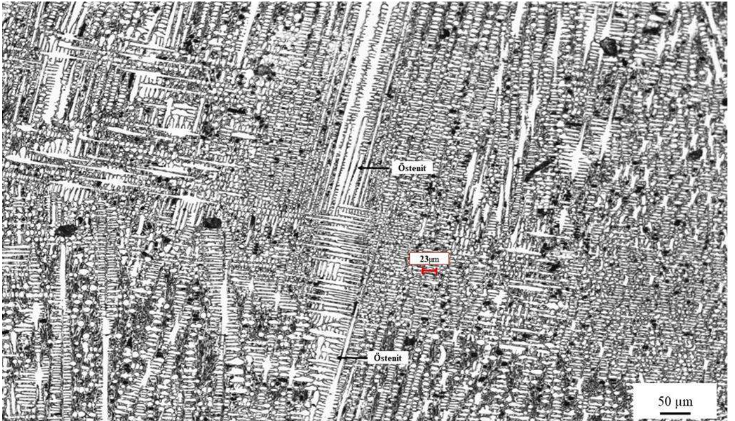
Şekil 4. 500 A kaynak akımı kullanılarak elde edilen kaplamanın optik mikroskop mikroyapı görüntüsü.
