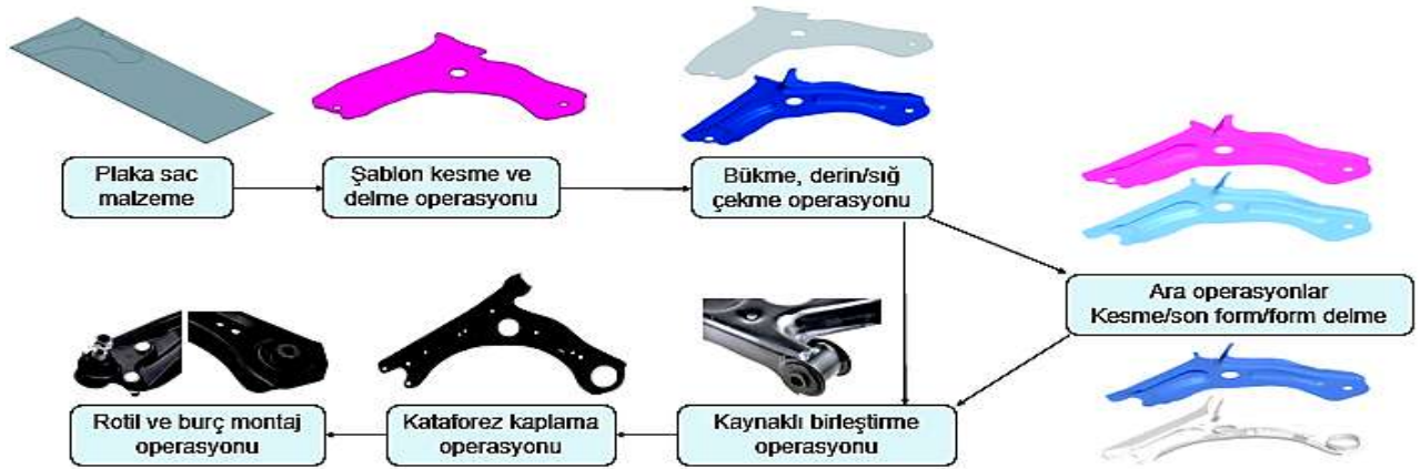
Şekil 6. Sac salıncak kolu üretim adımları
