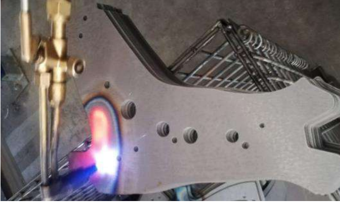
Şekil 20. S355MC şablon malzemeye bölgesel ısıtma işlemi uygulanması
