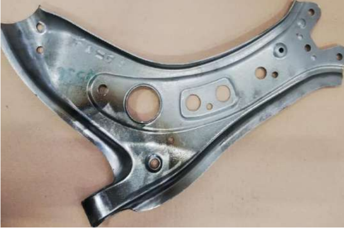
Şekil 24. S355MC malzemenin ısıtma işlemi, parlatma ve teflon film ile üretilen yırtılma problemi çözülmüş nihai ürün
