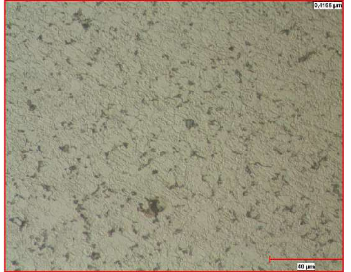
Şekil 22. S355MC Bölgesel ısıtma işlemi sonrası mikroyapı
