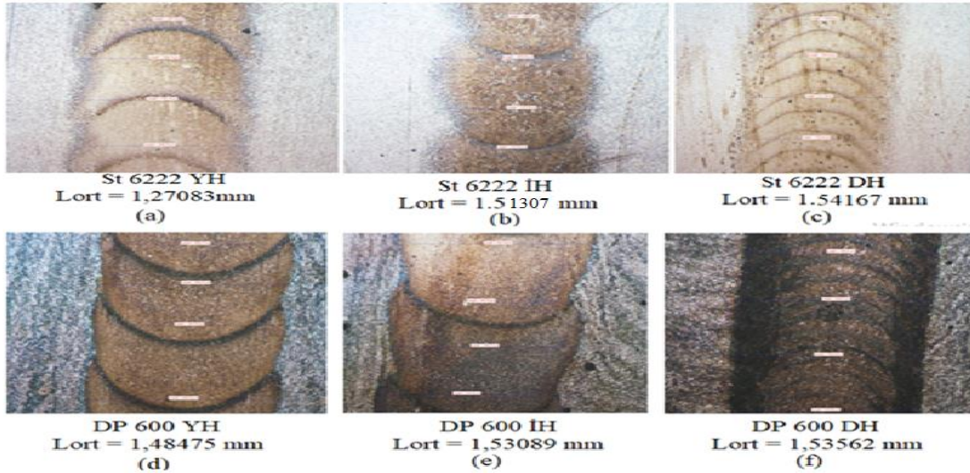
Şekil 3. Kaynak hızının kaynak dikişine etkisi (200X)
