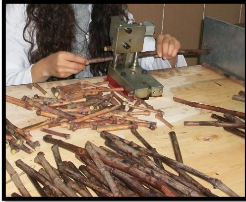
Şekil 2. Masabaşı omega aşısı makinesi ile aşılama
