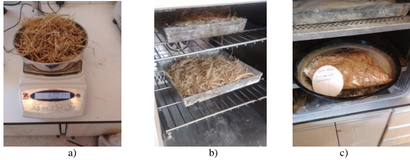
Şekil 2. a) Tam atık tavuk tüyü b) Kesilmiş atık tavuk tüyü c) Toz atık tavuk tüyü
