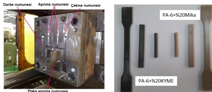
Şekil 1. Standartlara göre hazırlanan test numuneleri ve enjeksiyon kalıbı
