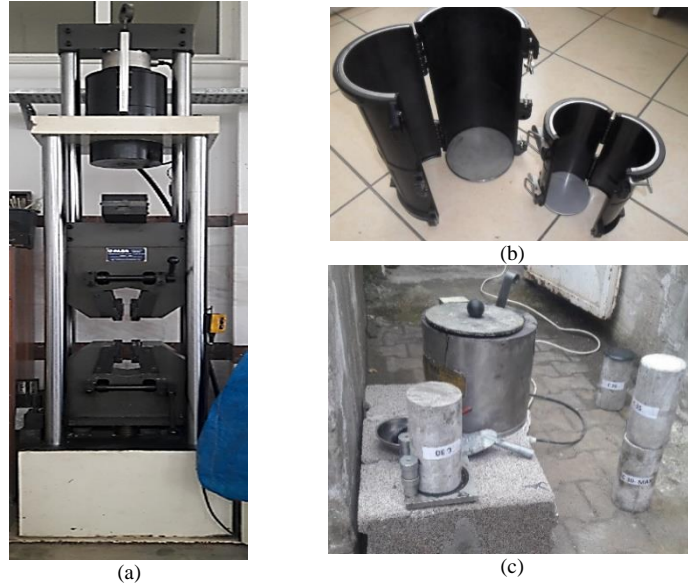
Şekil 1. (a) hidrolik test cihazı, (b) Numune kalıpları, (c) kükürt kazanı
