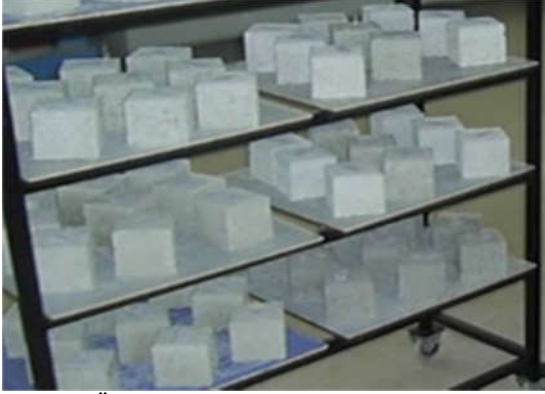
Şekil 4. Üretilen numunelerin havada kür edilişi
