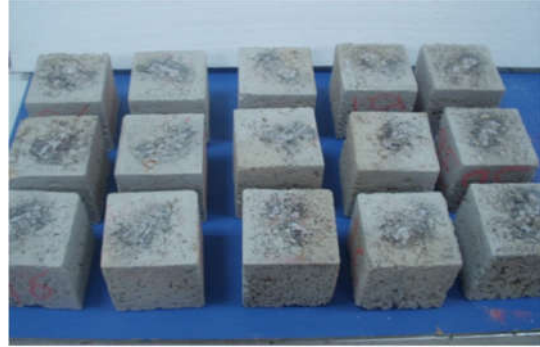
Şekil 6. Yüksek sıcaklık sonrası numunelerin genel görünümü
