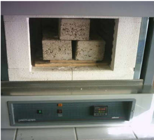
Şekil 5. Yüksek sıcaklık uygulanan fırın
