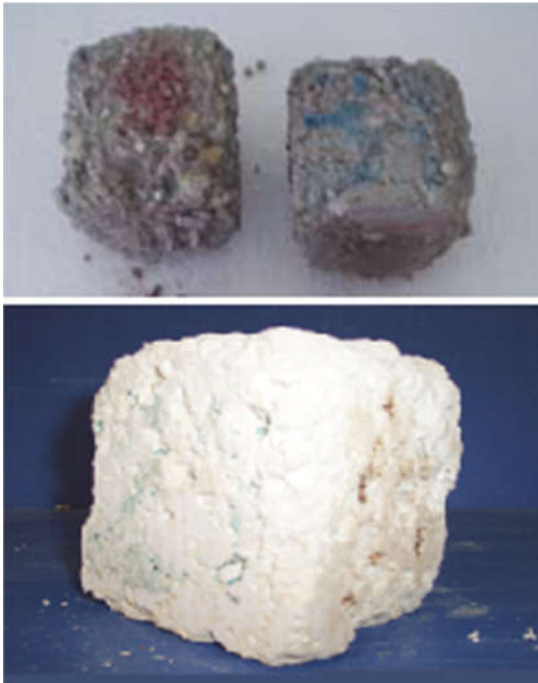
Şekil 9. Donma-çözülme sonrası numuneler
