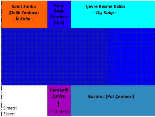
Şekil 3. Kullanılan sonlu elemanlar modeli ve kalıp sistemi bileşenlerinin şematik gösterimi
