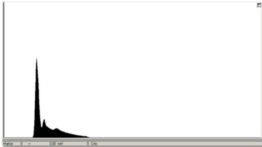
Şekil 1. ÇAFS cihazı ile alınan ^{137}\text{Cs} kaynağının doğrudan gama spektrumu
